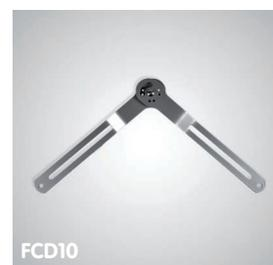
Articulación monocéntrica para la confección de férulas de codo. Posibilidad de limitar la extensión en 15° y la flexión en 45° y 75°, o de un arco flexo-extensor dependiendo de la posición de los tornillos de bloqueo.
